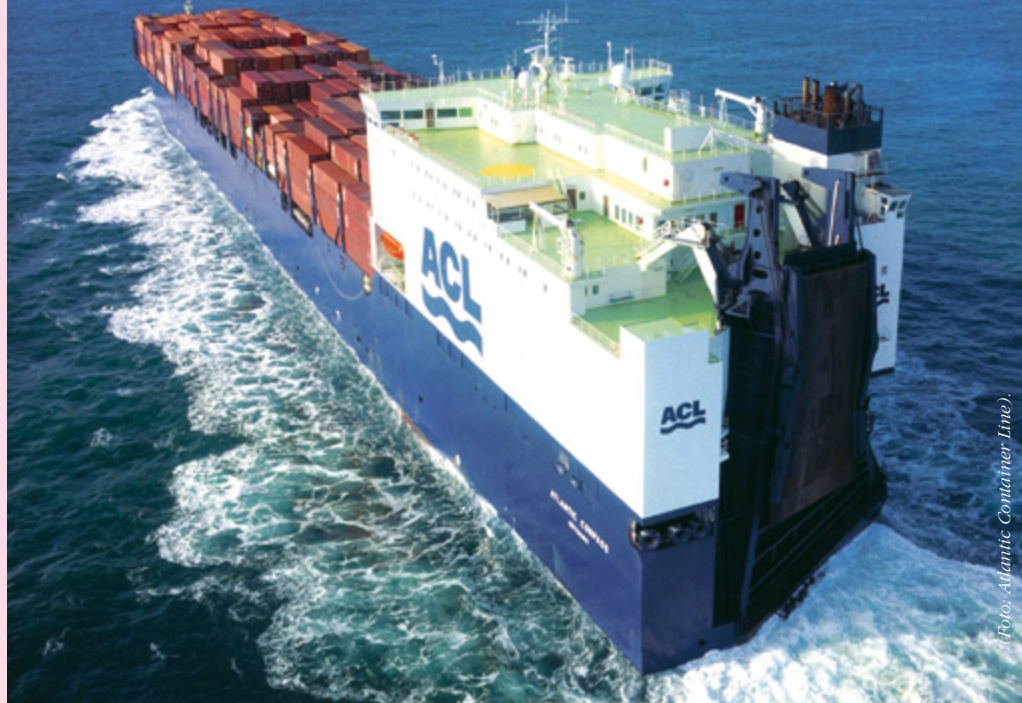
Abb. 2a Handelsschiff als Messplattform: Auf der Atlantic Companion führen wir zwischen Europa und der Ostküste Nordamerikas kontinuierliche CO 2 -Messungen in Atmosphäre und Oberflächenwasser durch.
