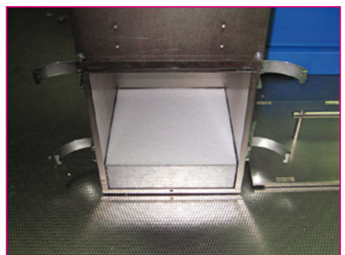
Abb. 2 Schneeprobe: Ins Kundtsche Rohr eingeschobene Schneeprobe (20 x 20 x 5 cm 3 ). Für die Messung wird die Öffnung des Rohrs mit dem daneben liegenden Deckel verschlossen.
