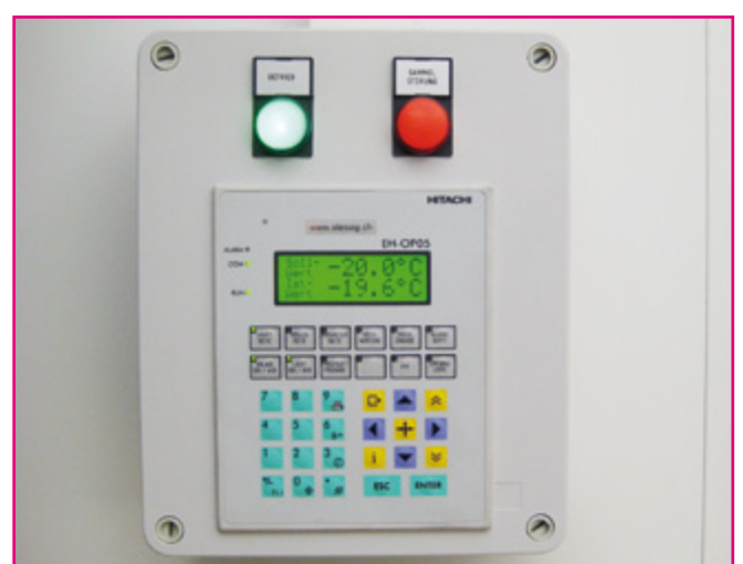
Abb. 3 Minus 20 Grad: Thermostatanzeige des Kältelabors mit dem Mikro-Computertomografen. Um Änderungen der Schneestruktur zu unterbinden, wird hier bei -20\text{ }^{\circ}\text{C} gearbeitet.
