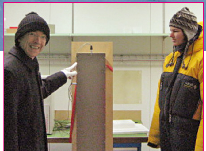
Abb. 1 Im Kältelabor: Messung des Schallabsorptionsgrads im vertikalen Kundtschen Rohr mit quadratischem Querschnitt in einem Kältelabor des SLF
