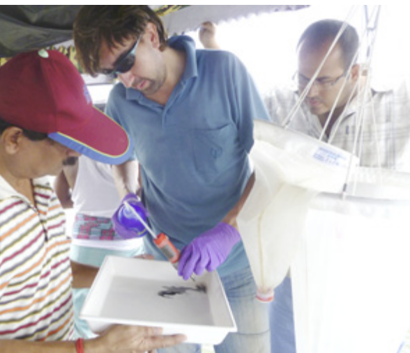
Ausspülen der Planktonnetzbecher , um die gesammelte Bakterien-Schwebstoff-Mischung direkt weiterzuuntersuchen.
