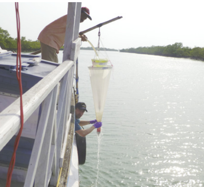
Fraktionierung des Wassers mithilfe von Planktonnetzen. So werden im Feld bzw. auf dem Wasser direkt Schwebstoffe, Bakterien und aufschwimmendes Material voneinander getrennt und analysiert.
