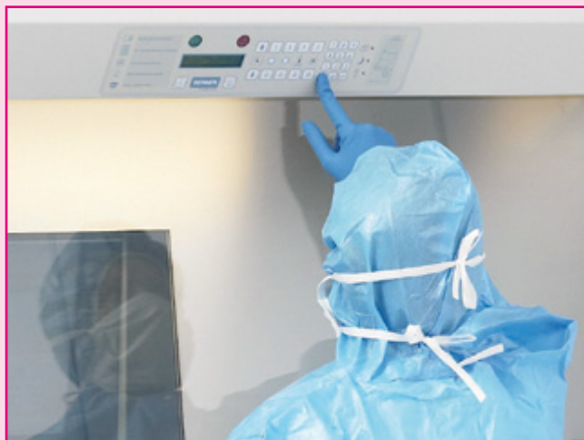
Abb. 6 Leicht erreichbare Bedienelemente und alle Anzeigen im Sichtbereich angeordnet.
