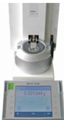
6 stellige Feinwaage für Volumen ab 0,1µl
