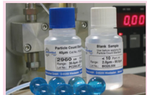
Abb. 2 Partikelzählstandard-Kits bestehen immer aus einer Blankprobe, einem Partikelzählstandard mit Magnetrührkern und einem Zertifikat
