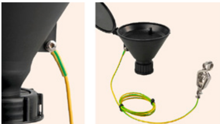
Abb. 6 Die sichere Erdung leitfähiger Komponenten verhindert Funkenentladungen. Auch ableitfähige Materialien müssen mit „Erde“ verbunden sein.
