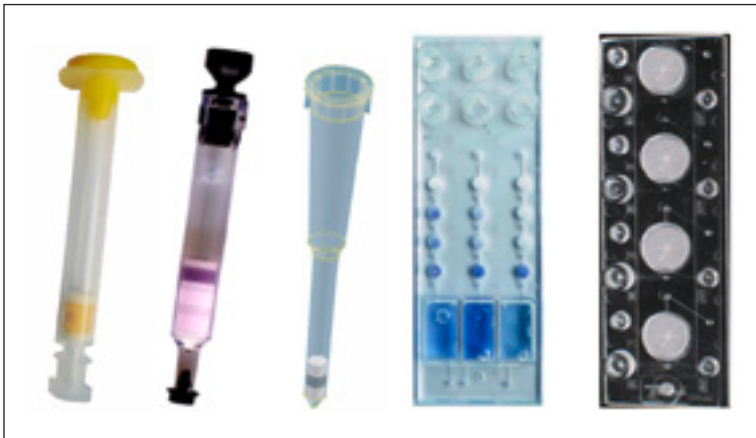
Abb. 3 Formate für immunologische Durchflussanalysen auf Basis von Affinitätsfiltern, links ABICAP (Antibody Binding Immuno Column for Analytical Purpose) mit Positiv-, Negativ- und Messfilter (von oben nach unten), Mitte analytische Pipettenspitze, rechts Lab-on-Chip der Fa. ChipShop GmbH Jena
